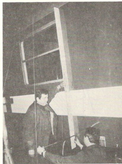
Slika 13 - Mjerenje horizontalne udaljenosti od toćke A do viska (mjera Y_1 )
