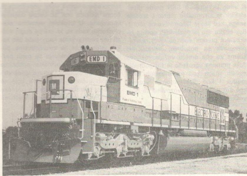
Slika 2 – Dizel-električna lokomotiva tipa SD-60 snage 3000 kW firme EMD-GMC, La Grange, SAD.
