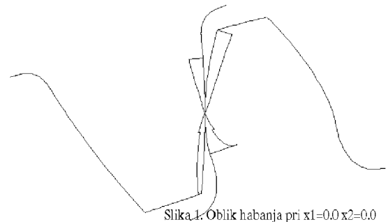
Slika 1. Oblik habanja pri x_1=0.0 x_2=0.0 Sl.7. Oblik habanja za zupčasti par sa pomeranjem x_1=0.0 i x_2=0.0
