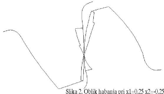
Slika 2. Oblik habanja pri x_1=0.25 x_2=-0.25 .8. Oblik habanja za zupčasti par sa pomeranjem x_1=0.25 i x_2=-0.25
