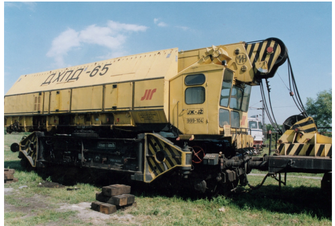
сл. 2. Шинска дизел хидраулична дизалица. Обавезан саставни део опреме помоћног воза, Секције за вучу возова Ниш, у интервенцијма већег обима
