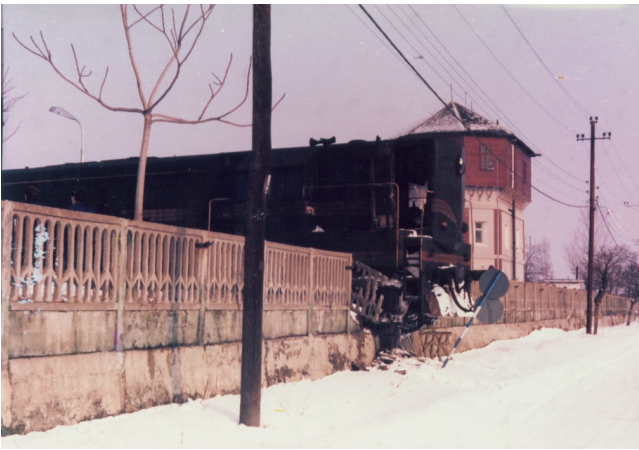
сл. 1. Непажљивим руковањем при маневрисању у ложионичком кругу, дошло је до ванредног догађаја који је проузроковао знатну материјалну штету. Олакшавајућа околност у овом случају је сазнање да није дошло ни до повређивања, нити до смртног случаја људства.
